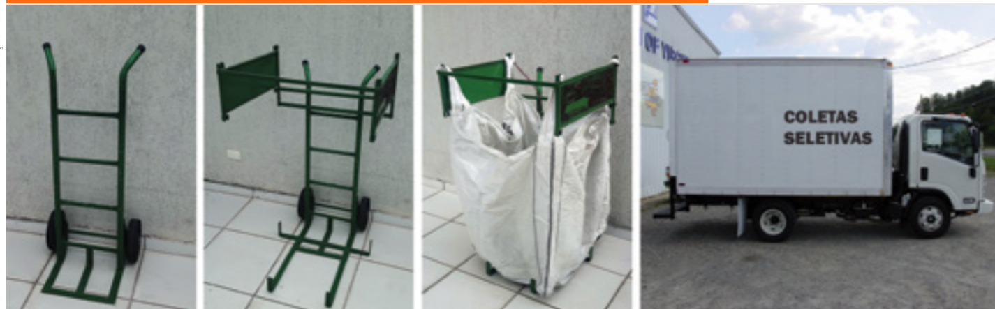
Foto 18 – Dispositivos para coleta seletiva mista (porta a porta com veículos leves e ponto a ponto com caminhão).
